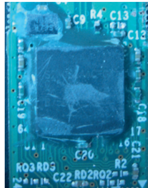
Een gietmassa van epoxyhars is bijzonder krachtig en bestand tegen oplosmiddelen. Maar met het juiste gereedschap kun je ook die verwijderen, zij het met veel moeite.
