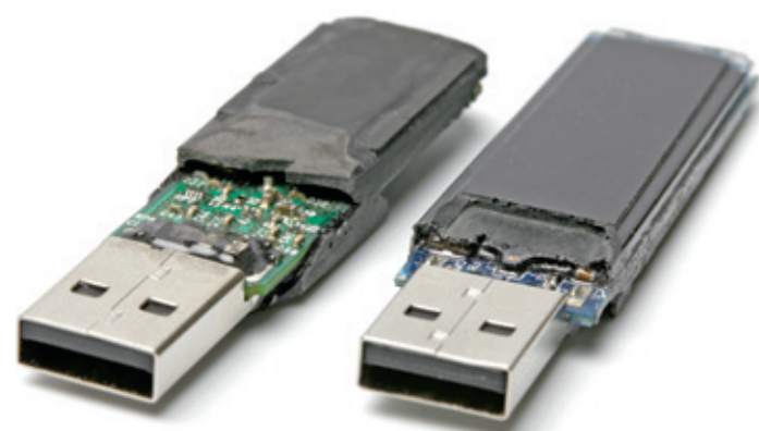
Ook nadat de zware behuizingen met geweld zijn geopend, zitten de printplaten van de DT5000 van Kingston en van de Ironkey nog in een dik pantser van een ontzettend sterke epoxyhars. Dat maakt een hardwareaanval niet onmogelijk, maar wel heel moeilijk en duur.
